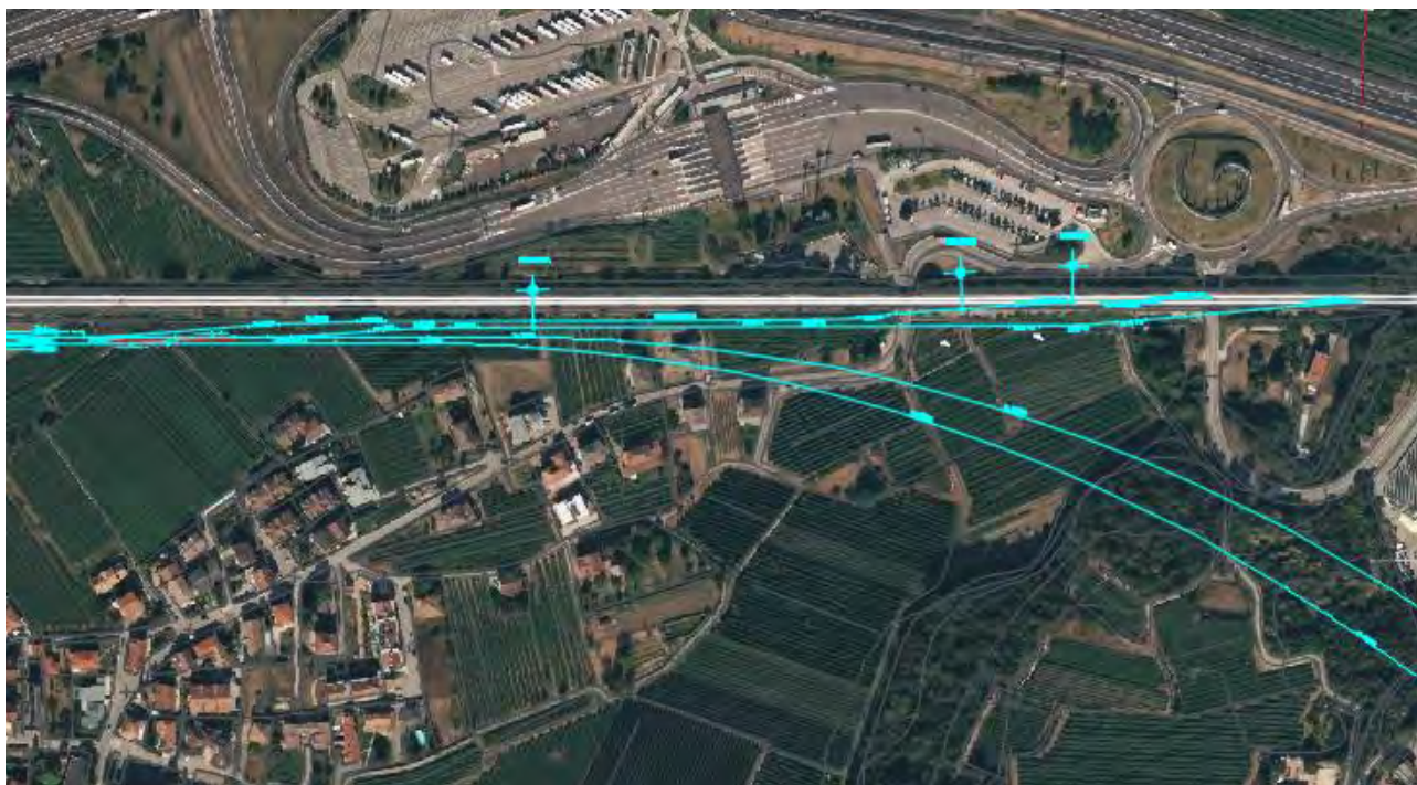
Figura 18-10 - Zona di comunicazione a 60 km/h tra la LS e la circonvallazione a Sud di Rovereto.
