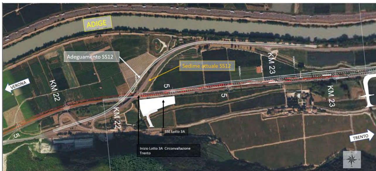
Figura 20-17 - Stralcio planimetrico con variante piano altimetrica della SS12
