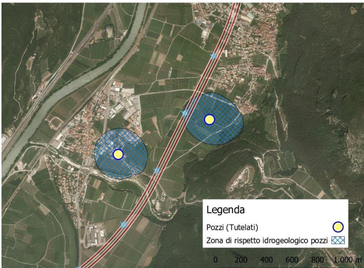
Figura 5 – Il passaggio delle gallerie esattamente nell'area che si trova tra i pozzi di approvvigionamento idrico di Calliano e di Besenello
